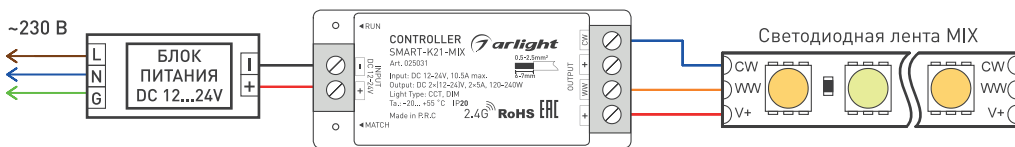
Рис. 1. Подключение светодиодной ленты MIX (CCT).
