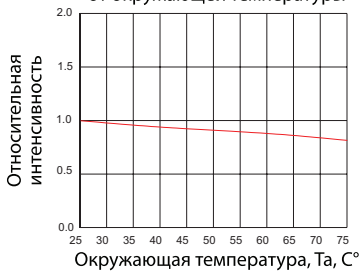
Зависимость относительной интенсивности от окружающей температуры
