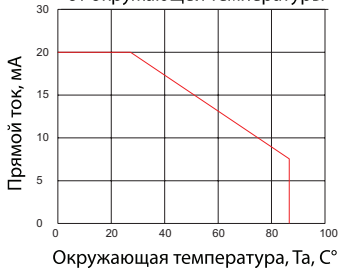
Зависимость прямого тока от окружающей температуры
